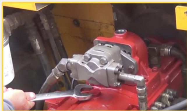
Depois de acoplar a bomba à escavadeira ela deve ser sangrada, para retirar qualquer bolha de ar que esteja no sistema hidráulico. Bolhas de ar fazem com que o conjunto rotativo trabalhe sem lubrificação gerando desgaste e cavitação, ou até quebra de alguma peça.
